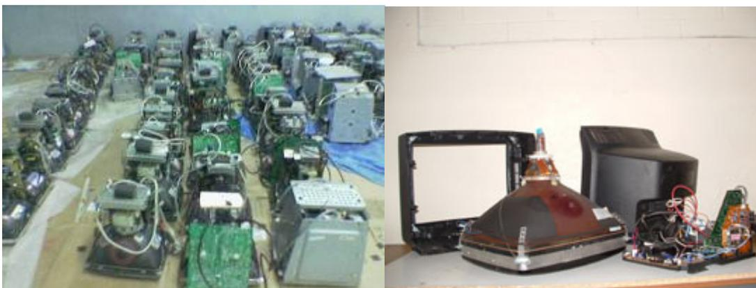
Desmontaje de los televisores y vista del detalle de sus componentes: TRC, plaquetas, carcasas plásticas y cables. <sup>20</sup>
